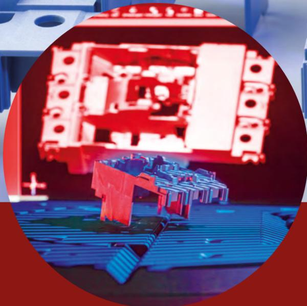
Vollständige Vermessung der Bauteiloberfläche per 3D-Scan: Erzeugung der Daten für eine Werkzeugkorrektur durch einen Soll-Ist-Vergleich
